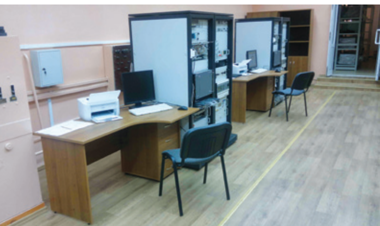
Лаборатория проверки бортового оборудования вертолетов Ми-8/17/171 на Улан-Удэнском авиационном заводе оснащена системой НАСКД-200
